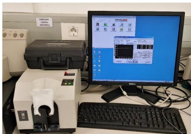
Slika 8. Remisijski spektrofotometar Spectraflash SF 300 PLUS-CT
