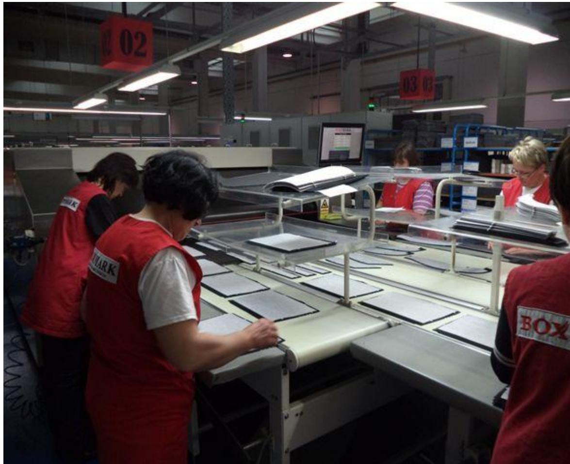
*Slika 10 Ulaženje krojnih dijelova u termo kanal radi aktiviranja ljepila za laminiranje*
