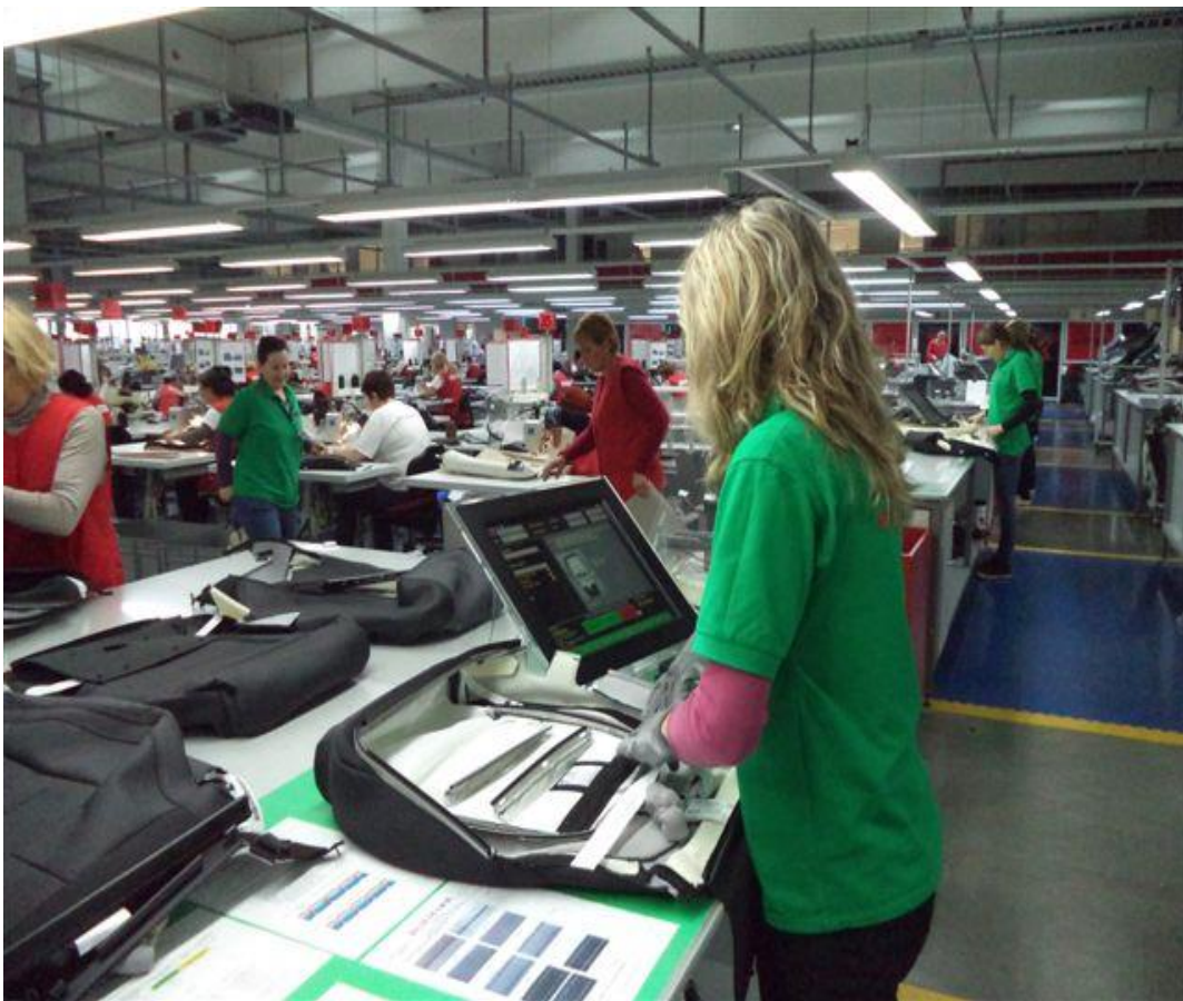
Slika 13 Završna kontrola po završetku tehnološkog procesa šivanja
