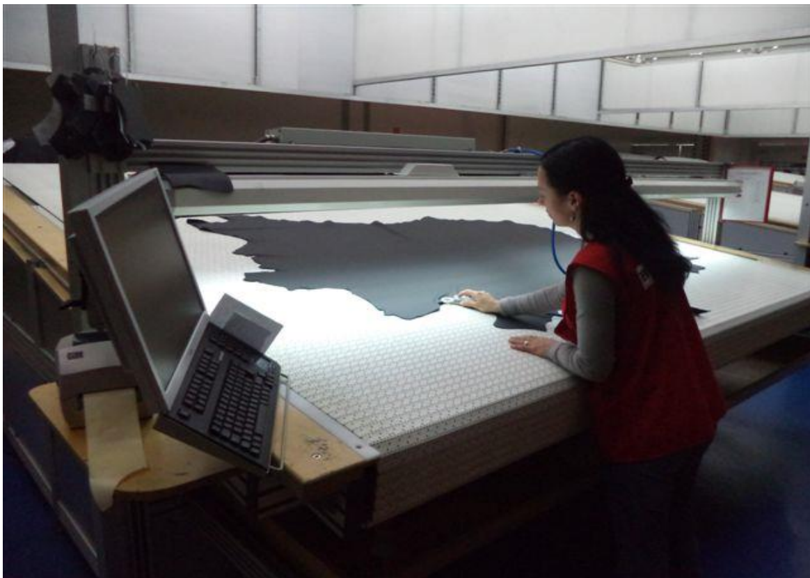
Slika 8 Pregled komada kože i bilježenje uočenih oštećenja
