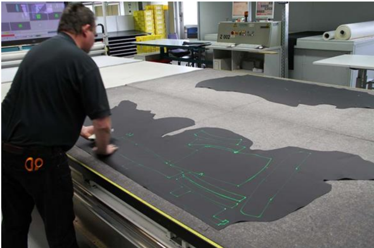
Slika 4 Kontrola krojne slike na komadu kože
