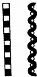
a) Presjek osnovine niti
