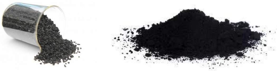
a) b) Sl.3 Aktivni ugljen u granulama (a) i praškasti aktivni ugljen (b) [15, 16]
