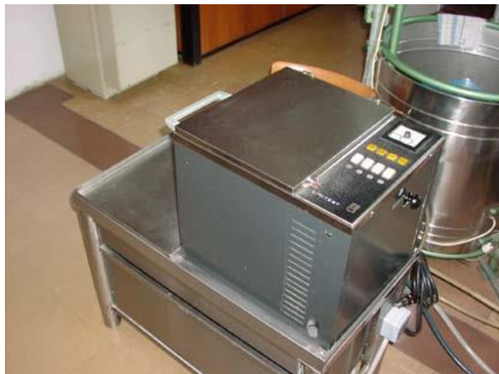
Slika 1: Uređaj za oplemenjivanje i bojadisanje - Linitest, Hanau
