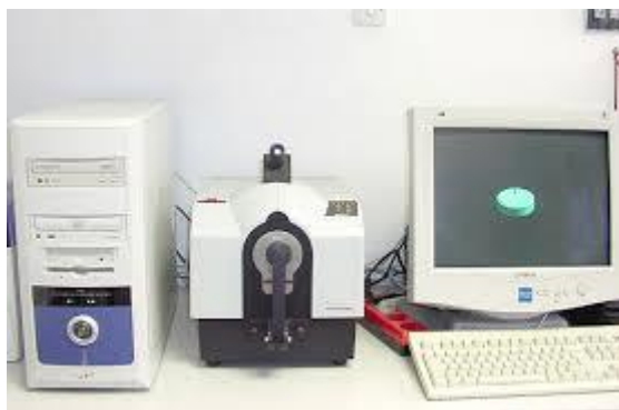
Slika 2: Remisijski spektrofotometar Spectraflash SF 300, tt. Datacolor
