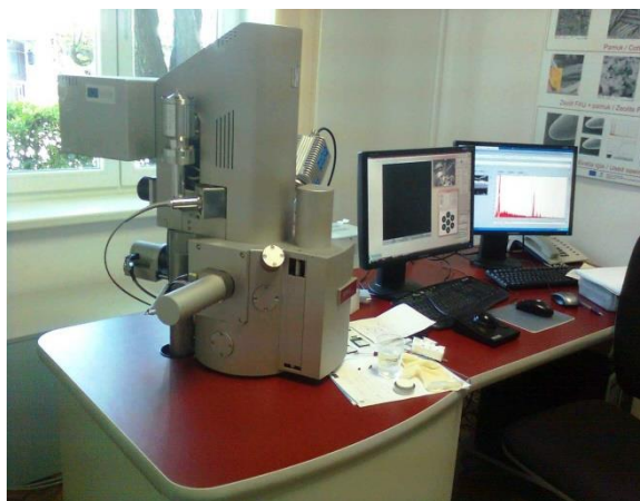
Slika 3: MIRA\\ FEG-SEM mikroskop
