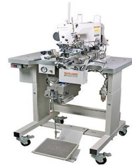
Slika 5. Šivaći automat za porublјivanje hlača [16]
