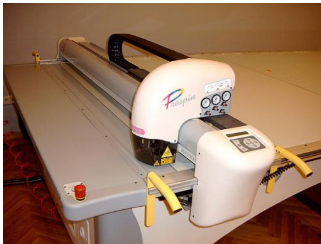
Slika 3. Agregat za iskrojavanje Lectra, Bordeaux – Cestas, France, PROSPINFASHION 72
