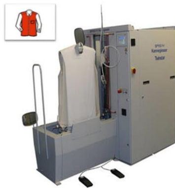
Slika 6. Stroj za tunelno glačanje [17]
