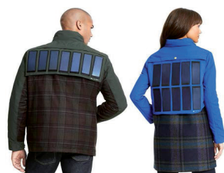
Slika 2. Jakne dizajnera Tommy Hilfigera s građenim solarnim ćelijama.
