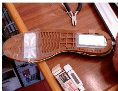
Slika 8. Prvi prototip cipele s ugrađenim piezoelektričkim polimerom u donjištu cipele.
