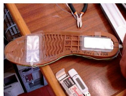
Slika 8. Prvi prototip cipele s ugrađenim piezolektričkim polimerom u donjištu cipele.
