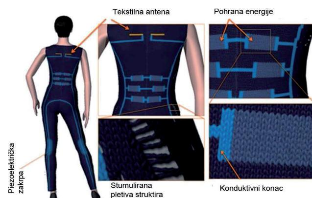
Slika 14. Dizajn donjeg rublja s ugrađenim piezolektričkim zakrpama, tekstilnim antenama i stimuliranimi pletenim strukturama.
