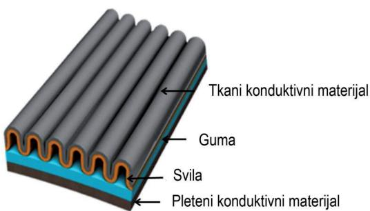
Slika 11. Korištenje triboelektričkih materijala za dobivanje električne energije.
