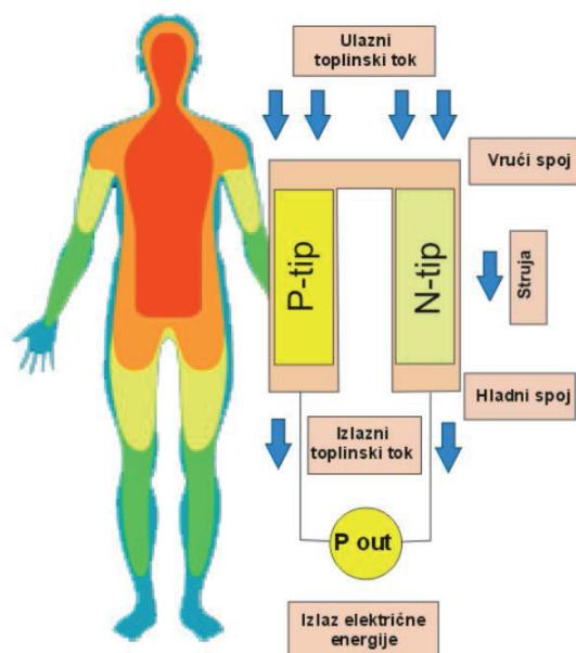
Slika 16. Prikaz postupka pretvorbe tjelesne topline u električnu energiju pomoću poluvodičkih termogeneratora.
