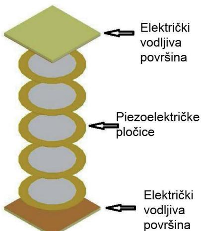
Slika 7. Ugradnja piezolektričkih pločica u uložak cipele.
