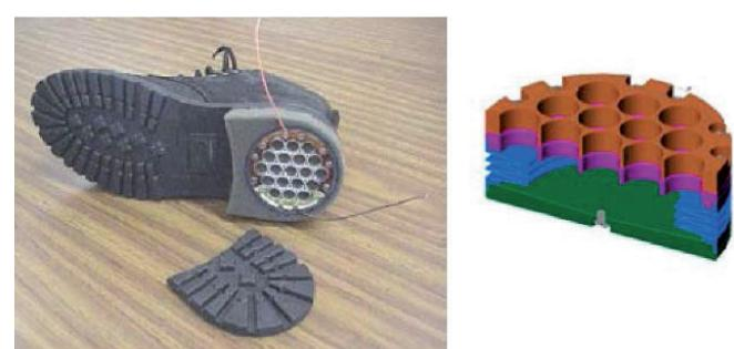
Slika 10. Dielektrični elastomerni filmovi ugrađeni u petu cipele.
