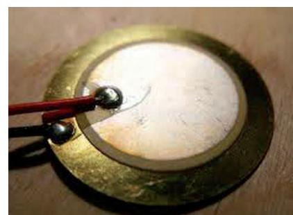
Slika 9. Piezolektrički disk ugrađen u obuću.
