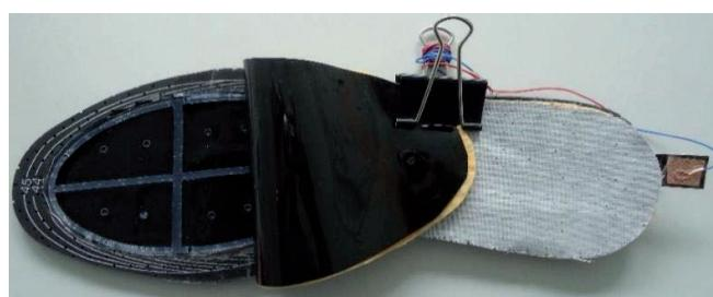
Slika 12. Umetak za cipele koji koristi triboelektrički efekt.
