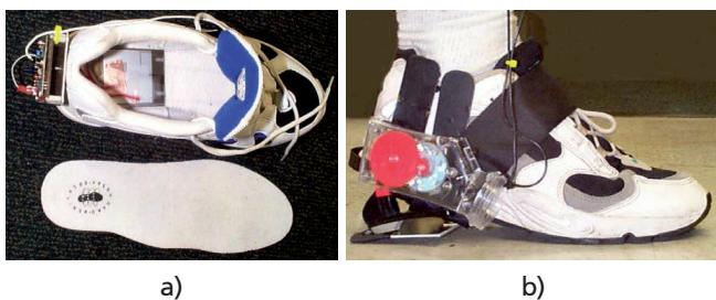
Slika 5. Rotacijski generator ugrađen u petu tenisice: a) unutrašnjost tenisice, vanjski izgled tenisice s ugrađenim generatorom.
