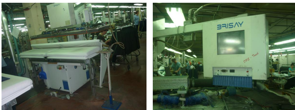
Slika 3.17. Stroj za glačanje (prešanje) marke Brisay
