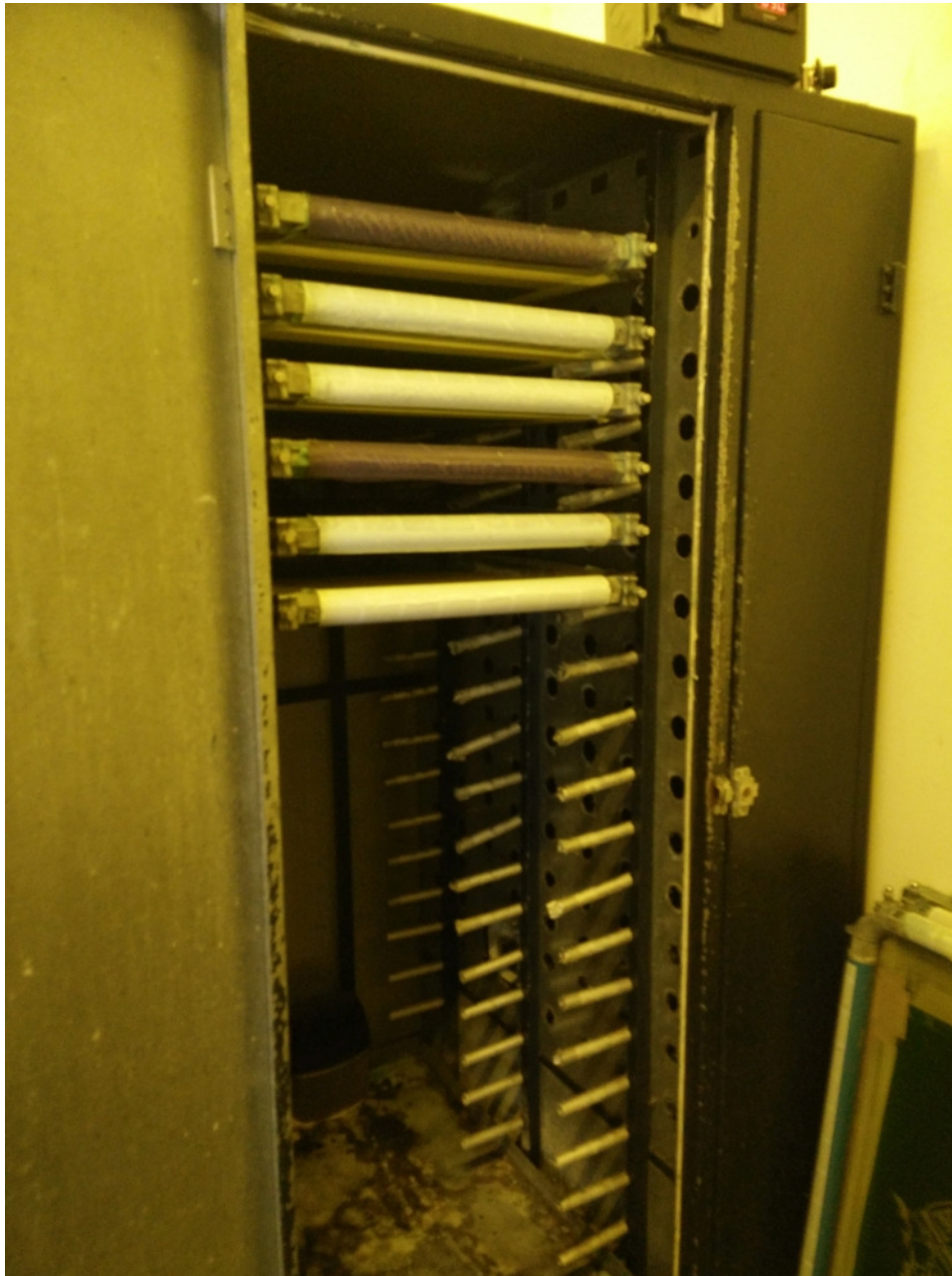
Slika 15: Sušilo za sita
