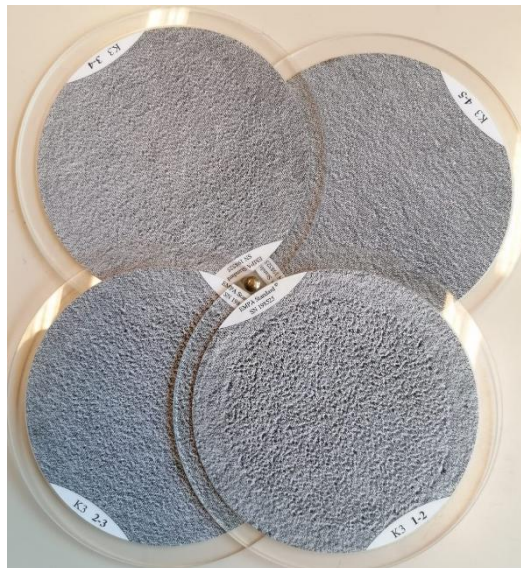
Slika 200. 2D etaloni sa pripadajućim ocjenama za ocjenu sklonosti nastanka površinskog pilinga
