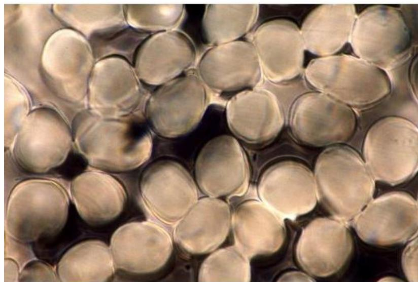
Slika 5. Poprečni presjek liocelnih vlakana, optički mikroskop [7]
