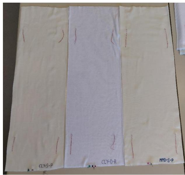
Slika 244. Epruvete načinjene za ispitivanje dimenzijske stabilnosti
