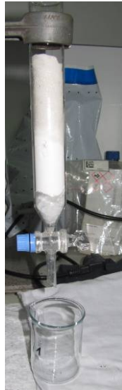
Slika 17. Staklena kolona s diatomejskom zemljom
