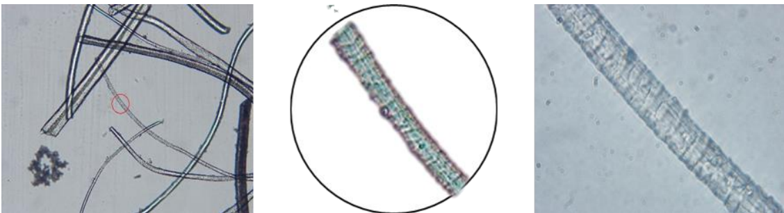
Slika 25. Mikroskopski izgled vlakana CP (x100 i x1000)
