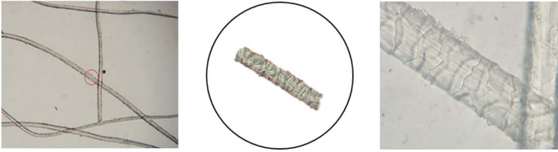
Slika 23. Mikroskopski izgled vlakana PP (x100 i x1000)
