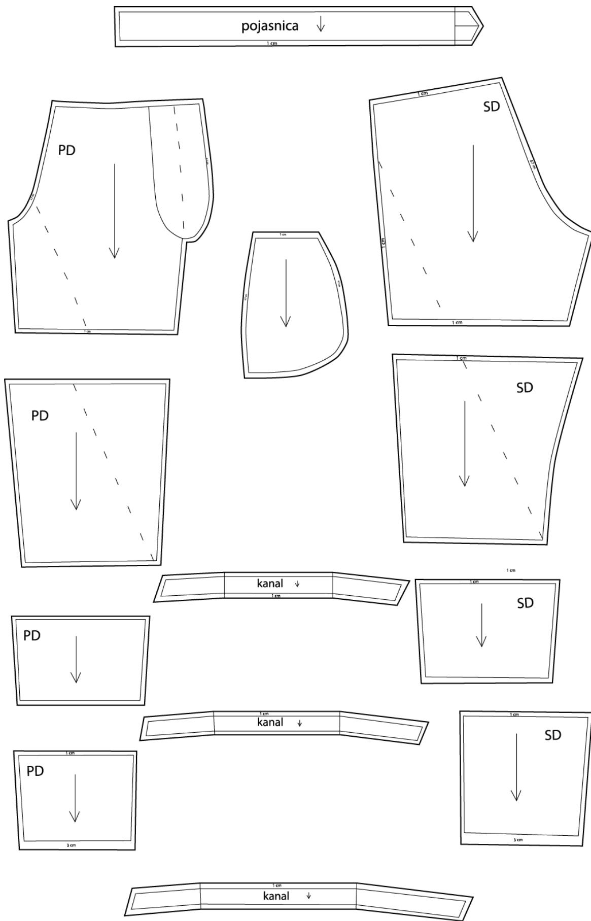
Slika 19. Krovni dijelovi ženskih hlača sa šavnim dodatcima
