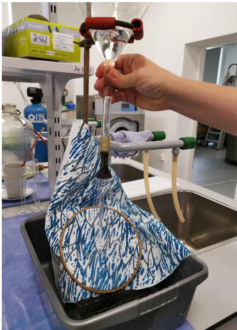
S1.20. Ispitivanje Spray testom.
