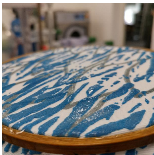
Sl.21. Prikaz vodoodbojnosti test 1.
