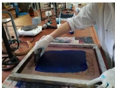
Slika 14: Preslikavanje uzorka pomoću šablone i rastirala
