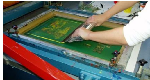
Slika 6: Prikaz tiska pomoću sita i šablone
