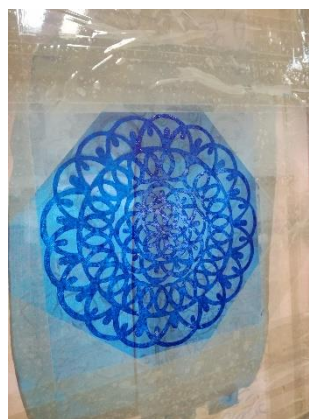
Slika 13: vidljivi uzorci na šablona gdje se tiskalo sa plavom i bijelom pastom
