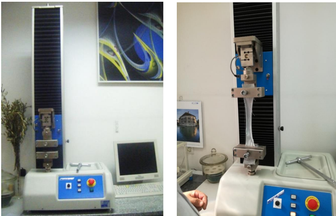
Slika 22: Dinamometar Tensolab, Mesdan
