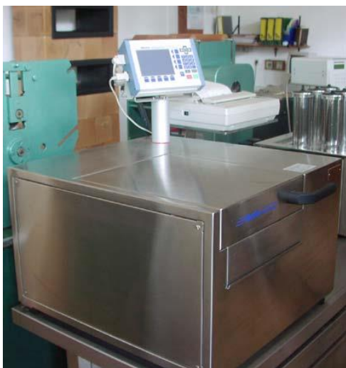
Slika 15: Laboratorijski uređaj za obradu Mathis, s pripadajućim bubnjem
