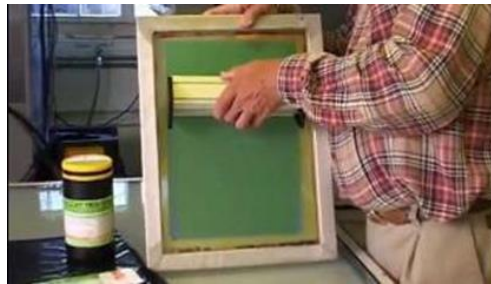
Slika 7: Premazivanje sita fotoemulzijom
