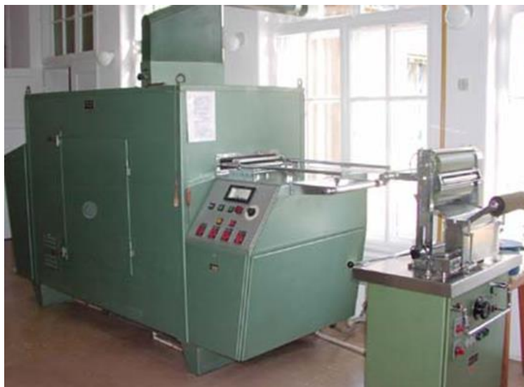
Slika 19: Rastezni sušionik s foulardom, Benz
