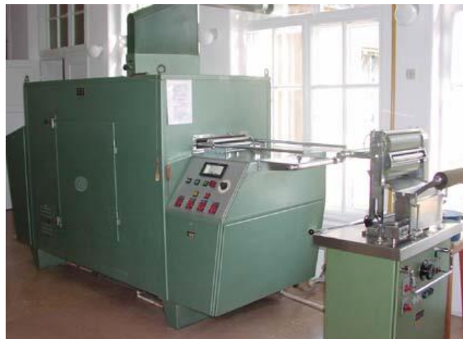
Slika 15: Sušionik rastezni sa fularom
