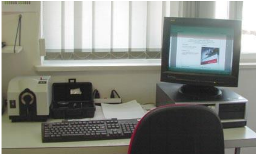
Slika 19: Spektrofotometar, Spectraflash SF 300
