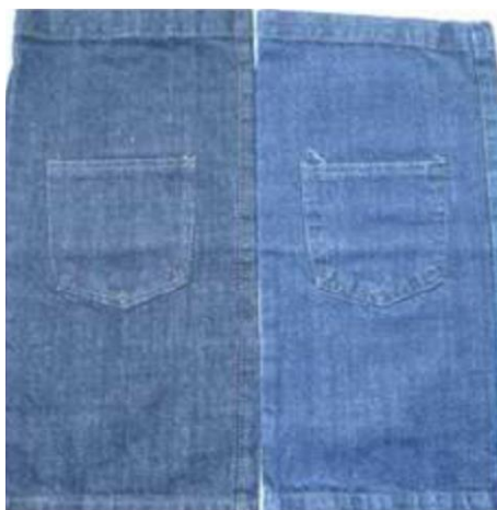
Slika 6: Džins obezbojen prije i nakon obezbojavanja s KMnO_4
