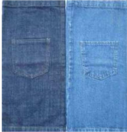
Slika 5: Džins prije i nakon obezbojavanja s NaClO
