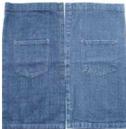
Slika 7: Džins prije i nakon obezbojavanja lakazama
