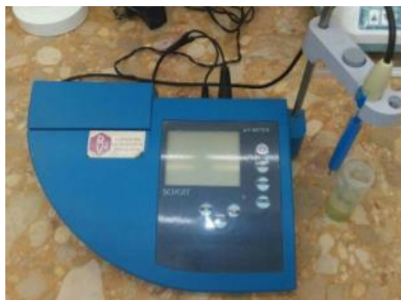
Sl. 10 pH metar CG 842, Scott, s elektrodom Blue Line 14, pH Geräte GmbH, Njemačka
