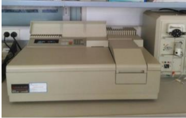
Sl. 9 Spektrofotometar Lambda 20, Perkin Elmer
