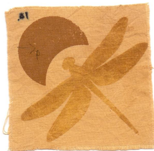
Slika 19. Uzorak predobrađen KAl(SO_4)_2 \cdot 12H_2O , bojadisan i tiskan - LUK
