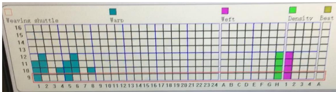
Sl. 19. Sučelje računala (specijaliziranog sustava), a) prvi dio veza (od prve do osme potke), b) drugi dio (od devete do dvanaeste potke)
