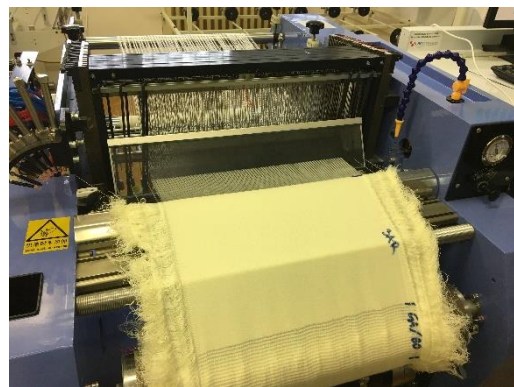
Sl. 20. a) spuštenu dodavač potke u trenutku tkanja uzoraka, b) izrada uzoraka
