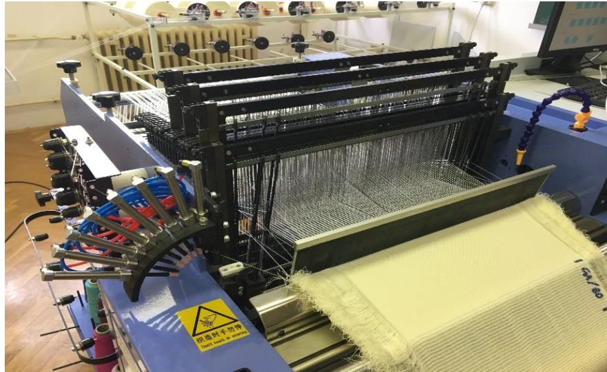
Sl. 12. Tkalački stroj za izradu uzoraka tkanine, Hefei Fanyuan Instrument DW598
