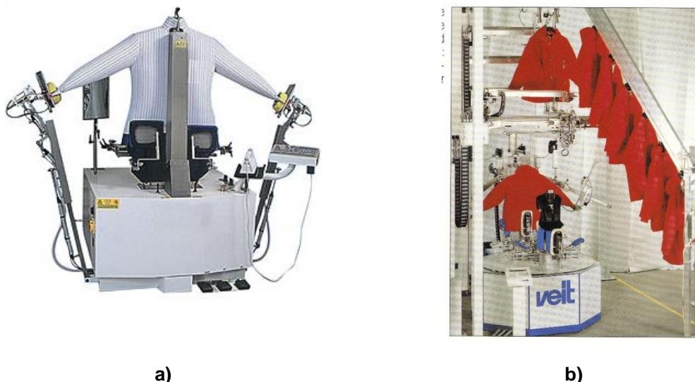
**Slika 5.** Strojevi za glaćanje **a)** s unutarnjim propuhivanjem **b)** tunelno glaćanje [17]
