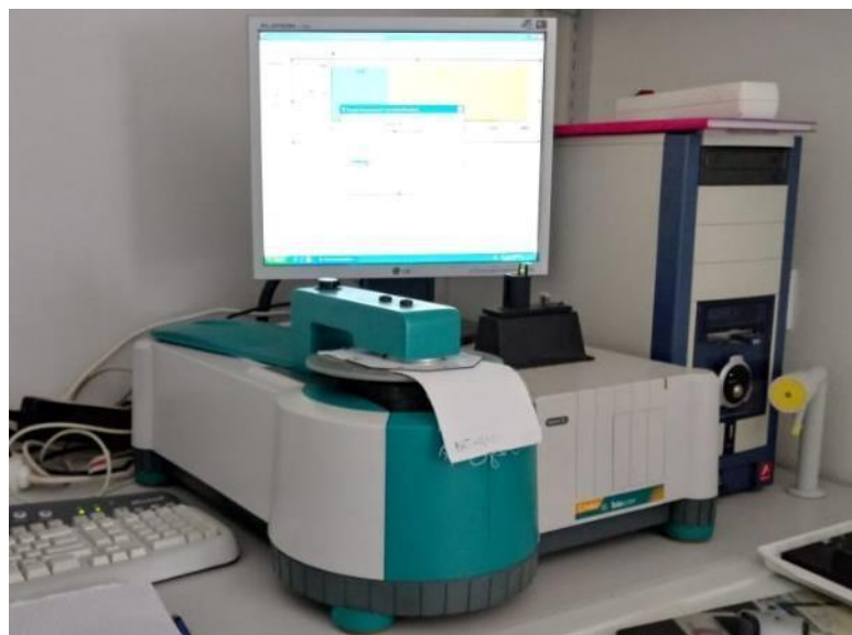
Slika 11. Transmisijski spektrofotometar Cary 50/Soloscreen (Varian)
