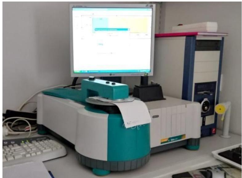
**Slika 11.** Transmisijski spektrofotometar Cary 50/Soloscreen (Varian)
