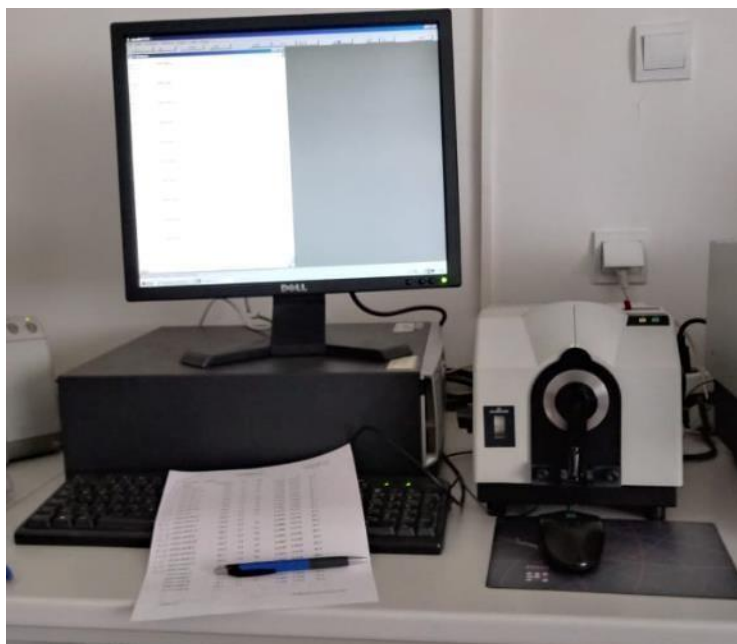
Slika 12. Remisijski spektrofotometar Spectraflash SF 300 (Datacolor)
