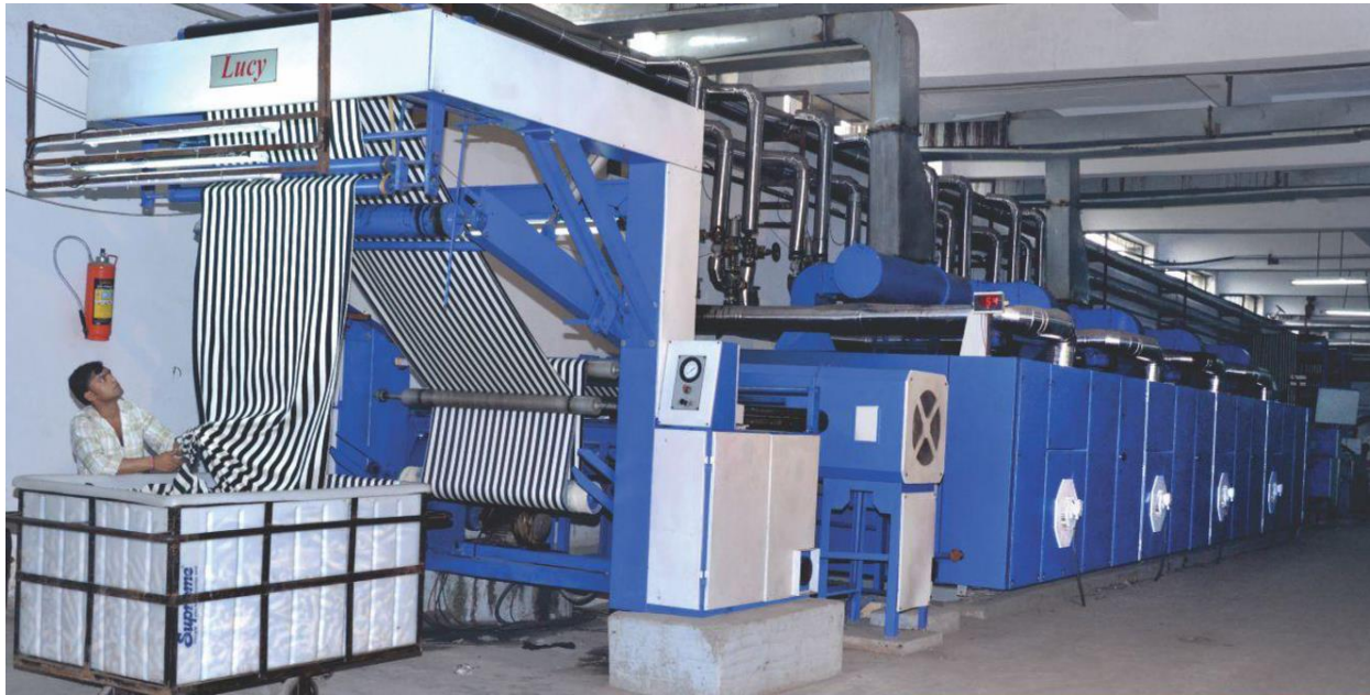
Slika 30. Primjer kontinuirane sušare tkanina (IZVOR: https://www.lucyengineering.com/stenter-machine.html )
