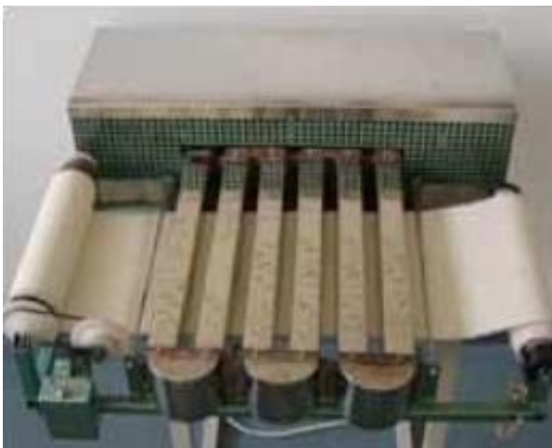
Slika 12: Uređaj za poboljšanu naknadnu obradu tekstilnog materijala primjenom mikrovalova (IZVOR: Katović i Bishof, 2004.)
