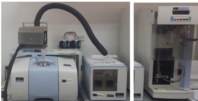
Prilog 1. Instrument spektrofotometar Perkin-Elmer Spectrum 100 i instrument za termičke analize Perkin Elmer Pyris 1 TGA Thermogravimetric analyzer
