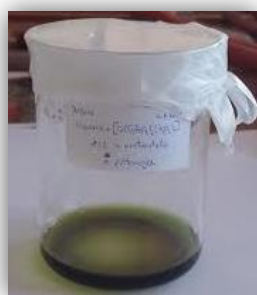
Sl.32. Matičnica nastala reakcijom 1H-benzimidazol-2-metanolom i diakvabis(2,4-pentandionato) kobalta(II) u molarnom omjeru 1:2 u acetonitrilu
