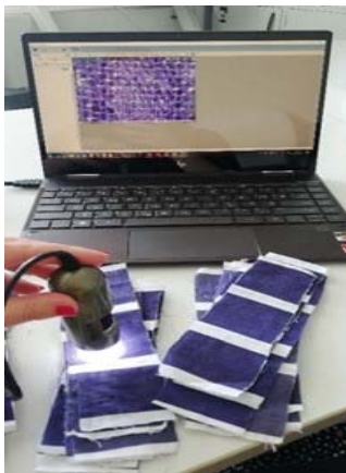
Slika 46. Mjerenje uzoraka pomoću Dino-Lite digitalnog mikroskopa
