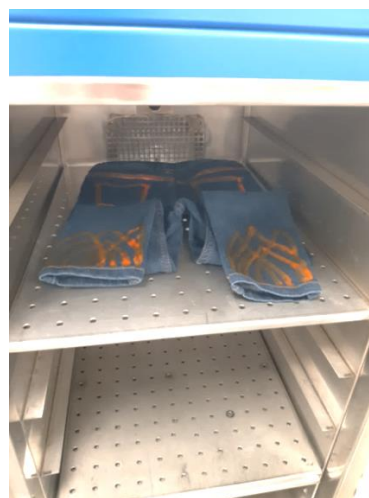
Slika 23. odjevni predmet pripremljen za sušenje i kondenzaciju
