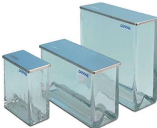
Slika 3. Komore za razvijanje s podijeljenim dnom [6].
