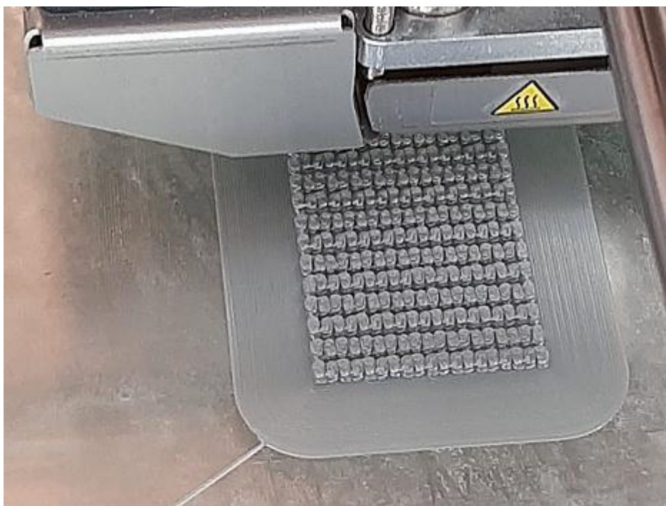
Slika 14. Postupak tiska pločice. Sa strane se nalazi potporni omotač koji je potrebno ukloniti.
