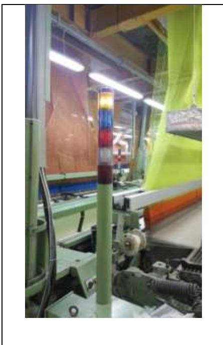
**Slika 7** Indikator svjetlo za signalizaciju prekida potke
