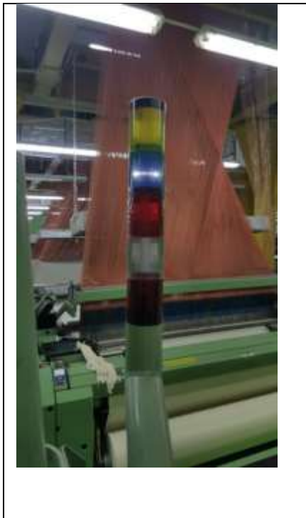
Slika 6 Indikator svjetlo za signalizaciju prekida osnove
