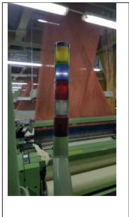
**Slika 6** Indikator svjetlo za signalizaciju prekida osnove
