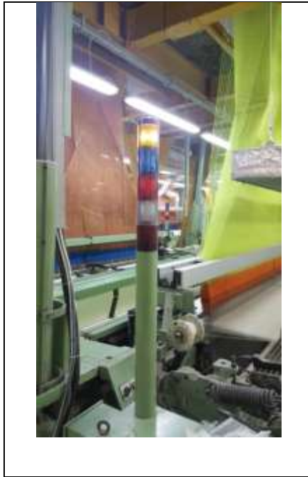
Slika 7 Indikator svjetlo za signalizaciju prekida potke
