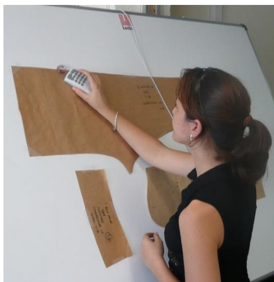
Slika 7 - Postupak digitalizacije krojnog dijela
