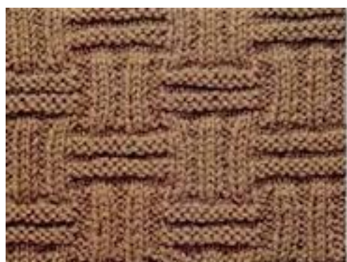
Slika 4. Lijevo-lijevi glatki kulirni preplet i uzorak uzorkovanog lijevo-lijevog pletiva
