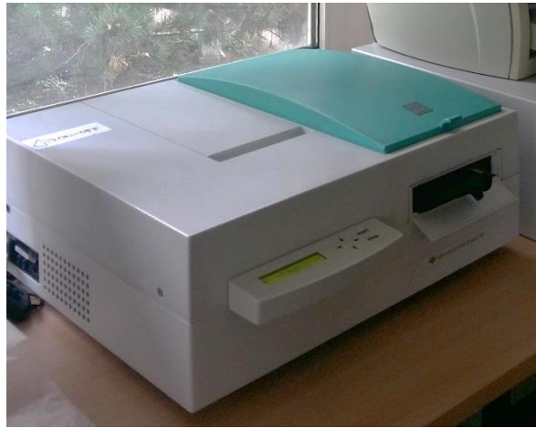
Slika 29. Čitač Labsystems iEMS MF, tip 1404, F6 filter
