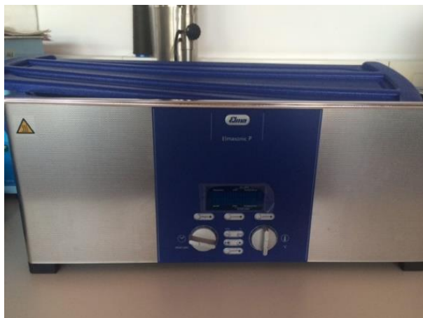
Slika 11: Ultrazvučna kada Zavoda za materijale, vlakna i ispitivanje tekstila
