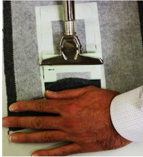
Sl.33 Postupak provjere čvrstoće spoja [26]
