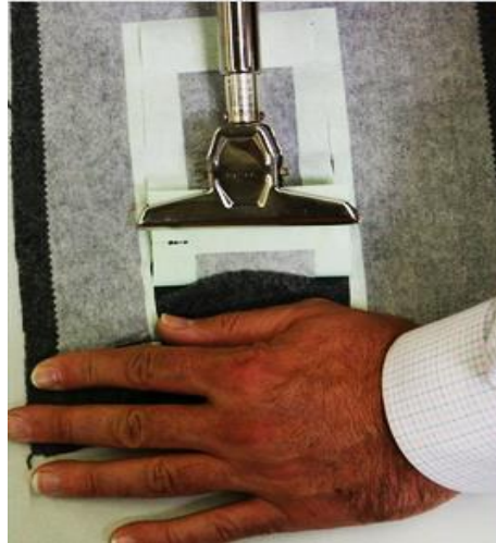
Sl.33 Postupak provjere čvrstoće spoja [26]
