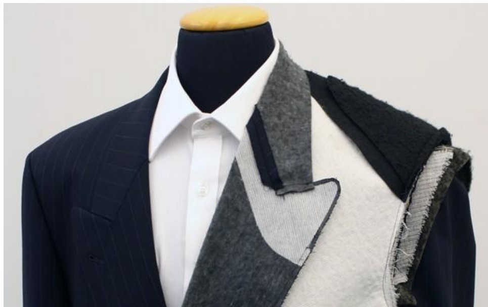
Sl.18 Primjer ugradnje različitih vrsta ljepljivih i neljepljivih međupodstava u muškom sakou [24]
