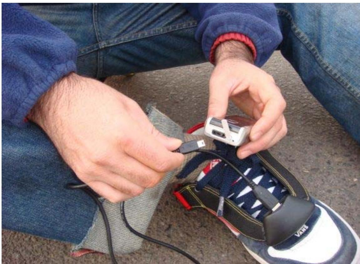
Sl. 13 Prototip tenisice s punjačem za mobitel
