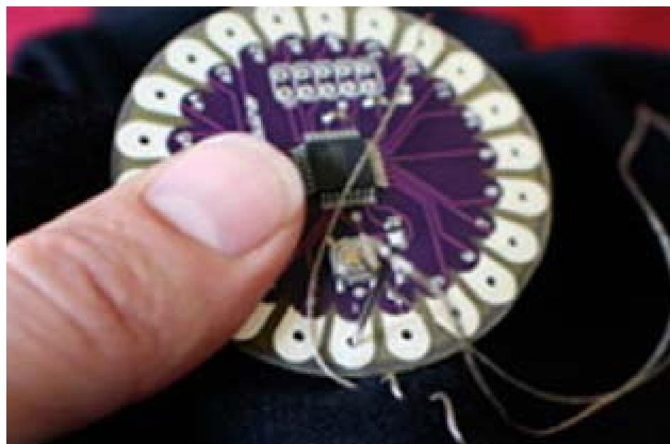
Sl. 25 Ušivanje LilyPad arduino ploče na body
