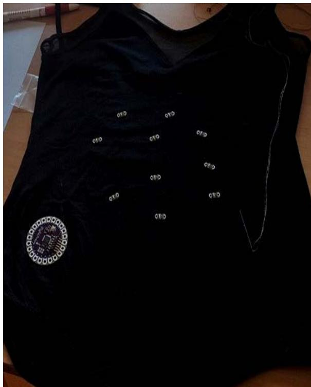
Sl. 24 Raspored svjetlećih dioda na body podlogu
