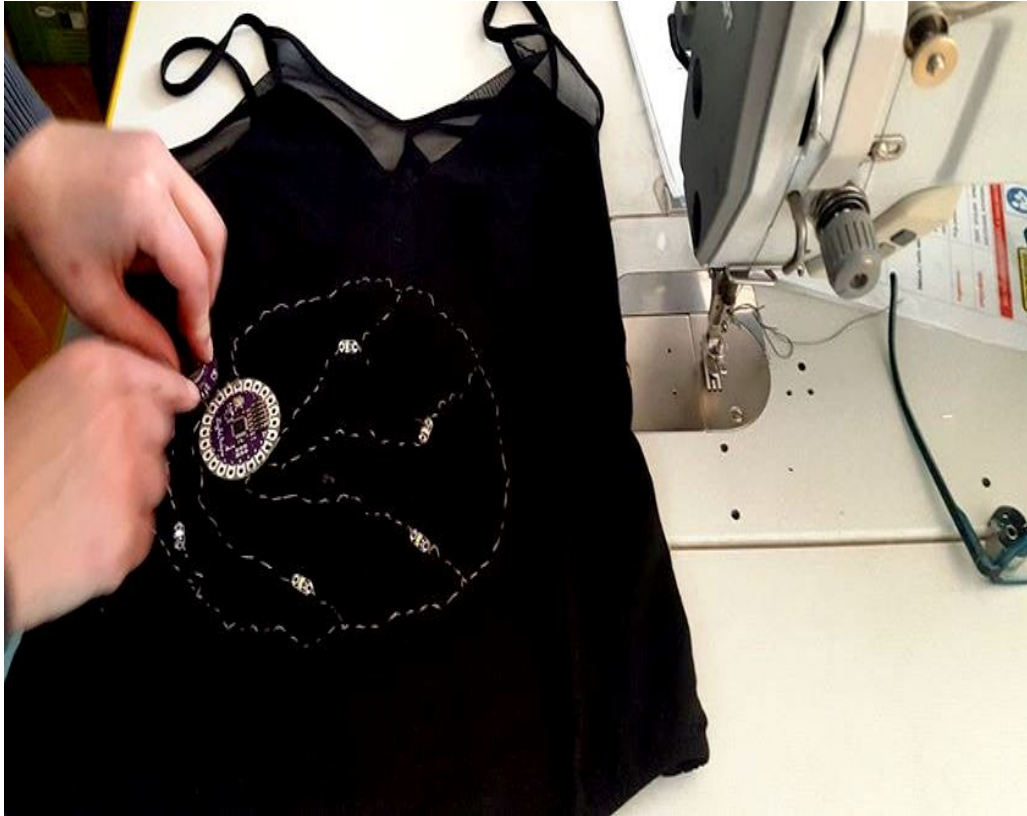
Sl. 27 Ušivanje baterijskog nosača
