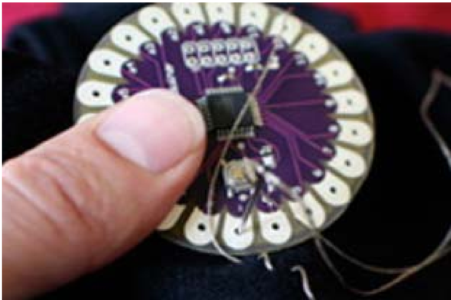
Sl. 25 Ušivanje LilyPad arduino ploče na body
