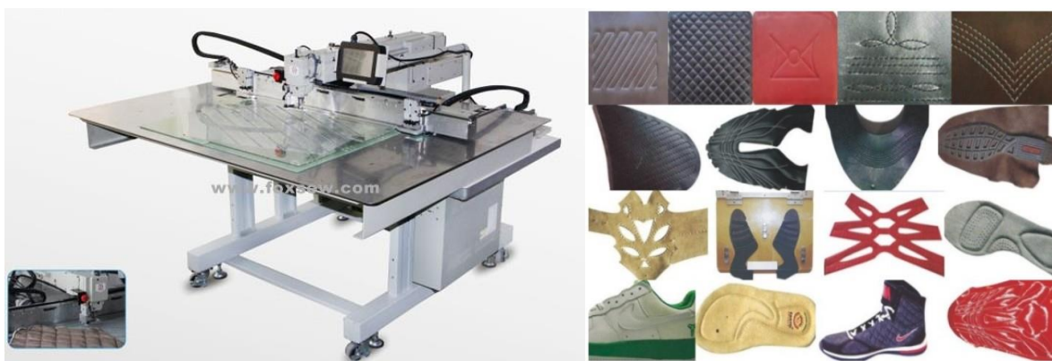
Sl. 29. Programabilni šivaći stroj za šivanje uzoraka [23]
