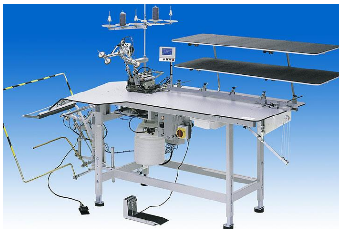
Sl. 8. Šivaći agregat za spajanje dugih šavova s konturnim vođenjem [12]
