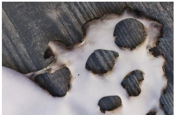
Slika 10. Prikaz pamučnog pletiva nakon intervencije paljenjem
