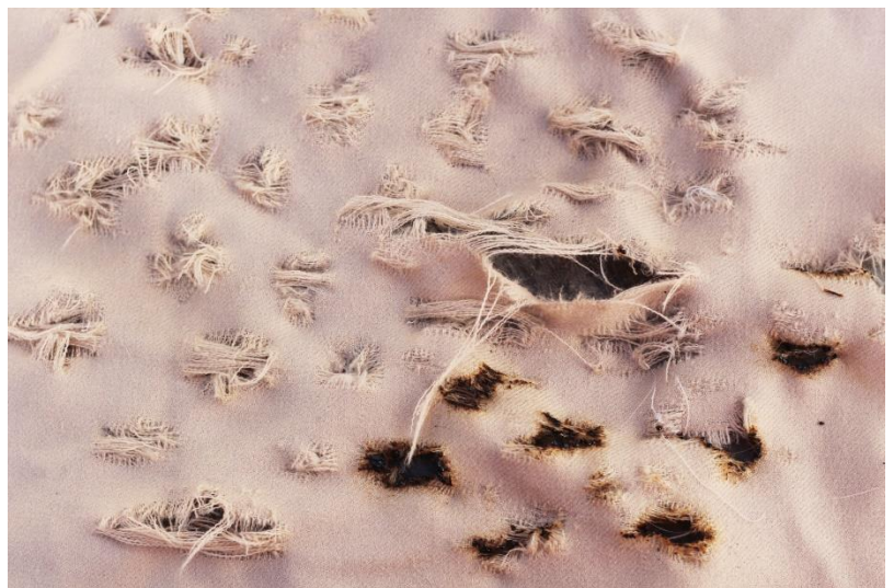
Slika 13. Prikaz vunene tkanine nakon mehaničke destrukcije i paljenja
