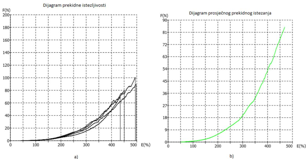
Sl.7.-3 Dijagrami sila/istezanje za uzdužne linearne uzorke djelomično platirnog pletiva 1+1 izrađenog s pređama finoće 20 dtex pri dubini kuliranja 550 jedinica:
