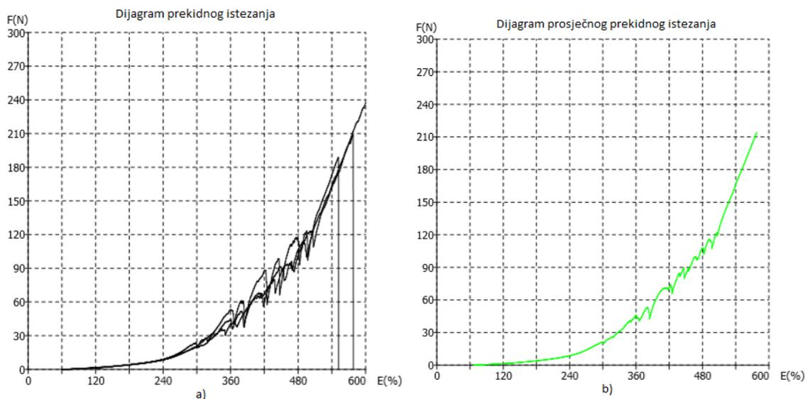
Sl.7.-12 Dijagrami sila/istezanje za uzdužne linearne uzorke potpuno platirnog pletiva izrađenog s pređama finoće 33 dtex pri dubini kuliranja 850 jedinica:
