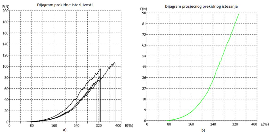
Sl.7.-5 Dijagrami sila/istezanje za uzdužne linearne uzorke djelomično platirnog pletiva 1+1 izrađenog s pređama finoće 20 dtex pri dubini kuliranja 850 jedinica:
