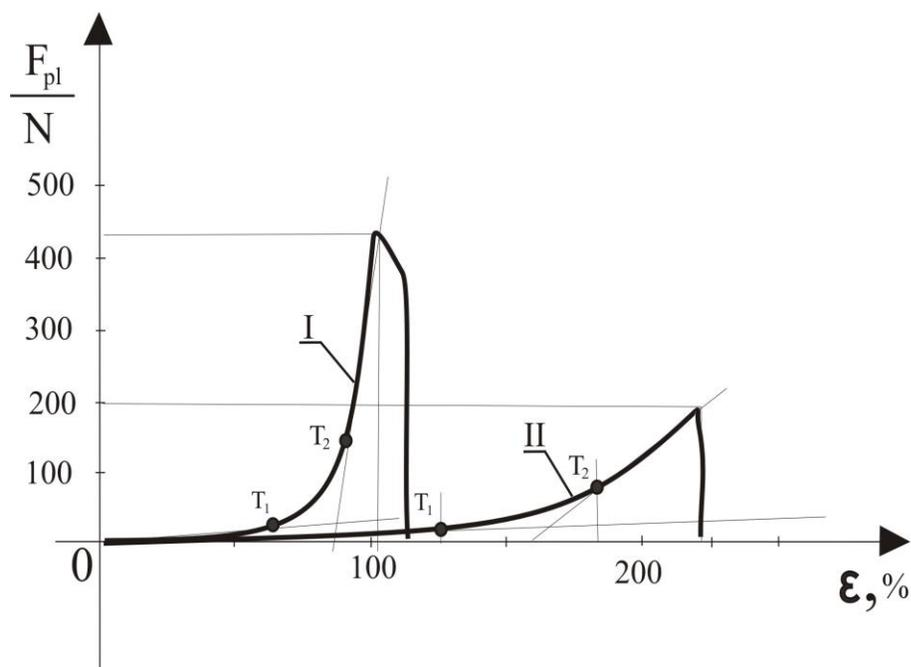
Sl. 4.-2 Općeniti dijagram sila/istežanje za desno-lijevano kulirno pletivo; I) u smjeru nizova očica i II) u smjeru redova očica;  $T_1$  - kraj elastičnog područja,  $T_2$  - točka infleksije, početak plastičnog područja
