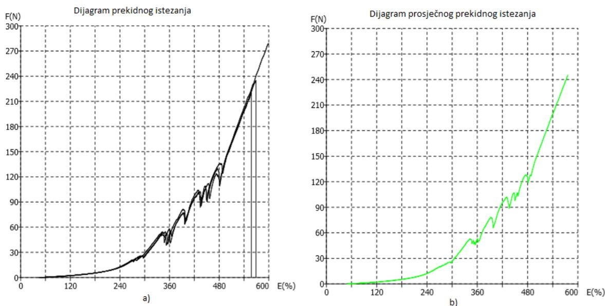
Sl.7.-11 Dijagrami sila/istezanje za uzdužne linearne uzorke potpuno platirnog pletiva izrađenog s pređama finoće 33 dtex pri dubini kuliranja 700 jedinica:
