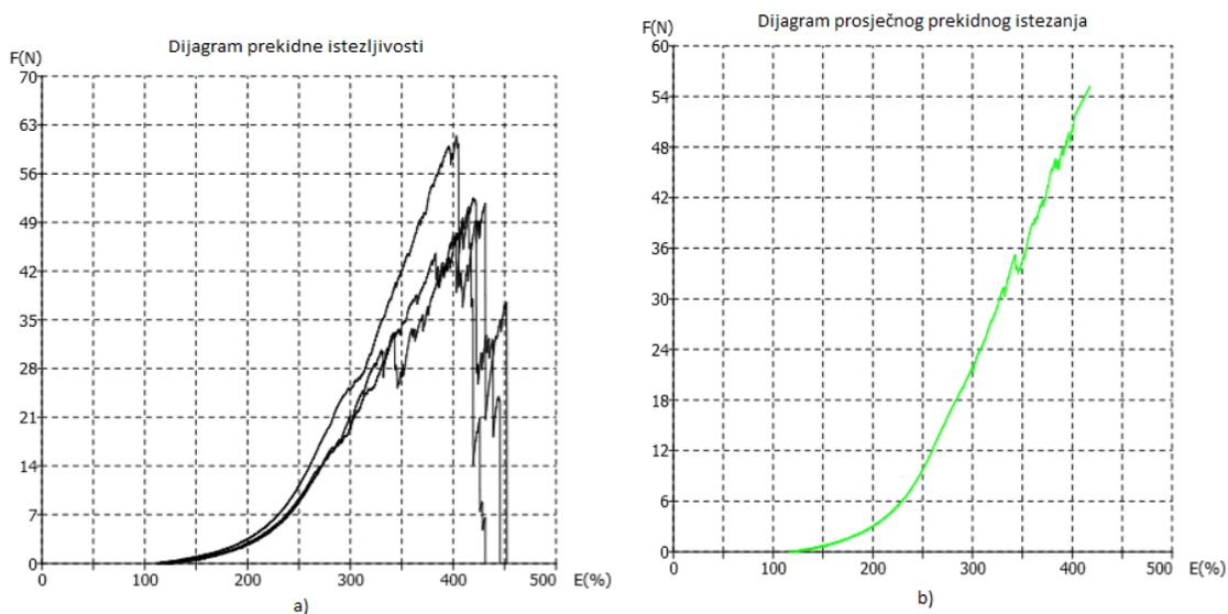
S1.7.-9 Dijagrami sila/istezanje za poprečne linearne uzorke djelomično platirnog pletiva 1+1 izrađenog s pređama finoće 20 dtex pri dubini kuliranja 850 jedinica:
