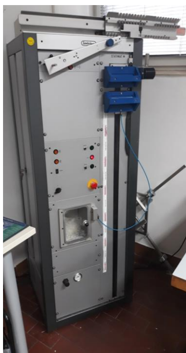
SI.7.-2 Dinamometar za trganje uzoraka pletiva: a) radno polje i b) razmak između hvatalica
