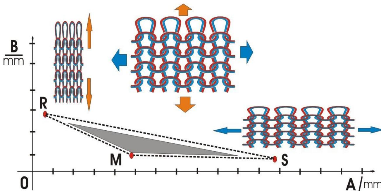
Sl. 4.-3 Opći dijagram poprečnog i uzdužnog istezanja desno-lijevog pletiva finih ženskih čarapa;  $A$  - korak očice, mm,  $B$  - visina reda očica, točke:  $M(A, B)$ ,  $S(A_{\max}, B_{\min})$ ,  $R(B_{\max}, A_{\min})$
