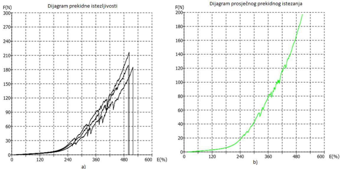
Sl.7.-14 Dijagrami sila/istezanje za poprečne linearne uzorke potpuno platirnog pletiva izrađenog s pređama finoće 20 dtex pri dubini kuliranja 700 jedinica:
