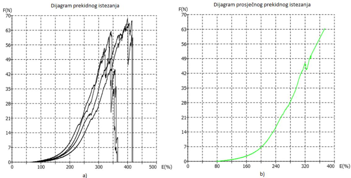
S1.7.-8 Dijagrami sila/istezanje za poprečne linearne uzorke djelomično platirnog pletiva 1+1 izrađenog s pređama finoće 20 dtex pri dubini kuliranja 700 jedinica:
