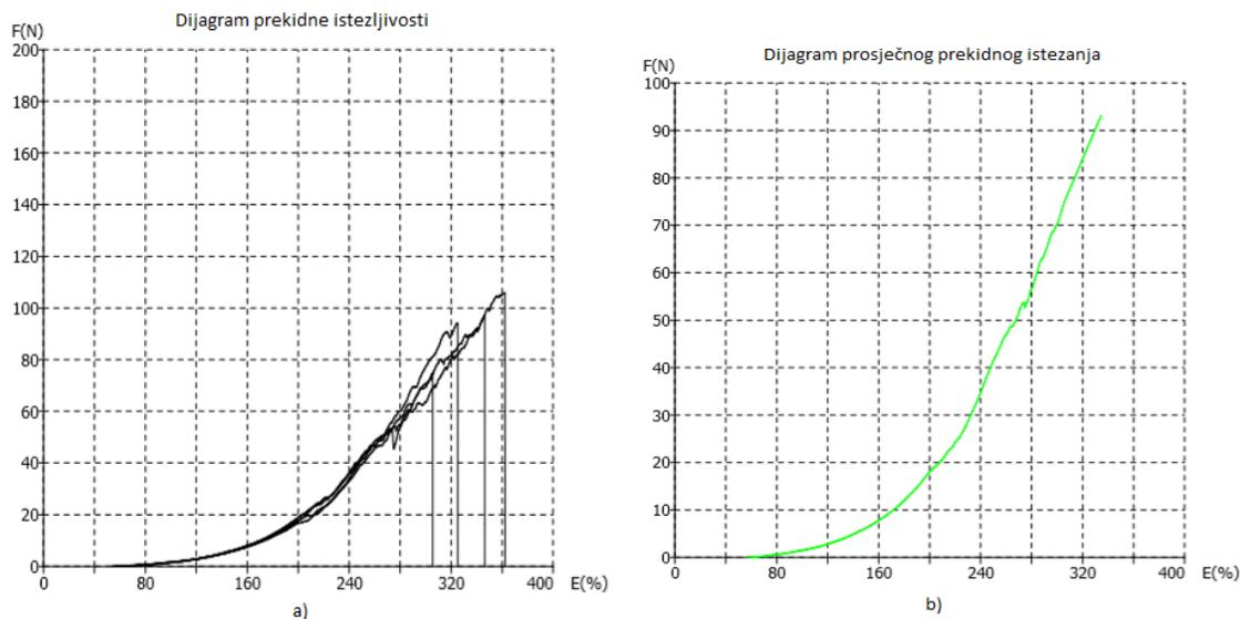
Sl.7.-4 Dijagrami sila/istezanje za uzdužne linearne uzorke djelomično platirnog pletiva 1+1 izrađenog s pređama finoće 20 dtex pri dubini kuliranja 700 jedinica:
