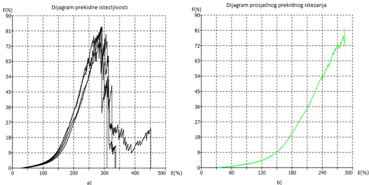
Sl.7.-7 Dijagrami sila/istežanje za poprečne linearne uzorke djelomično platirnog pletiva 1+1 izrađenog s pređama finoće 20 dtex pri dubini kuliranja 550 jedinica:
