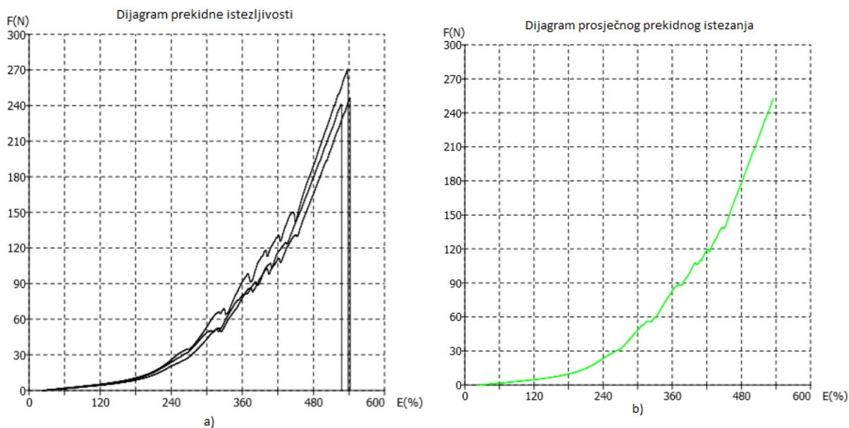
S1.7.-10 Dijagrami sila/istezanje za uzdužne linearne uzorke potpuno platirnog pletiva izrađenog s pređama finoće 33 dtex pri dubini kuliranja 550 jedinica:
