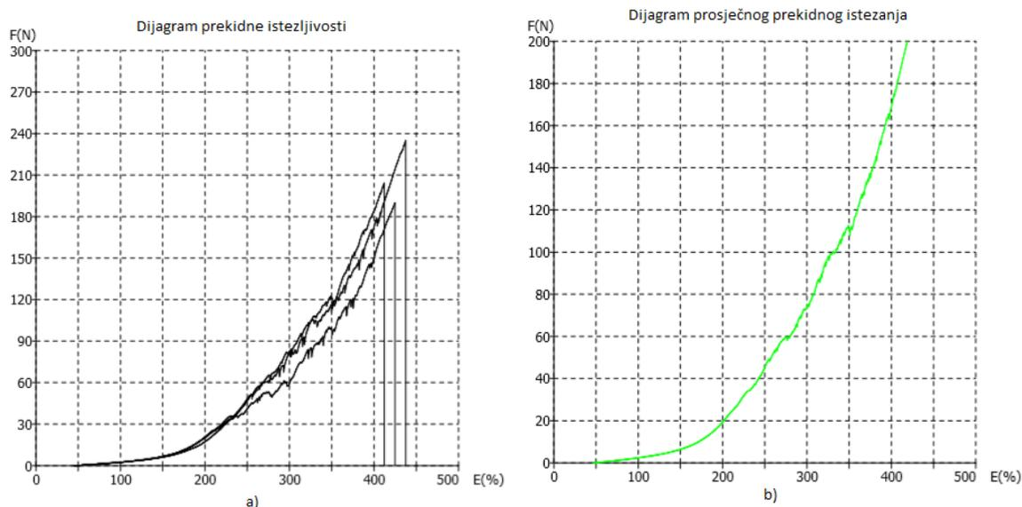
Sl.7.-13 Dijagrami sila/istezanje za poprečne linearne uzorke potpuno platirnog pletiva izrađenog s pređama finoće 20 dtex pri dubini kuliranja 550 jedinica:
