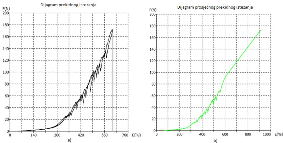
Sl.7.-15 Dijagrami sila/istezanje za poprečne linearne uzorke potpuno platirnog pletiva izrađenog s pređama finoće 20 dtex pri dubini kuliranja 850 jedinica:
