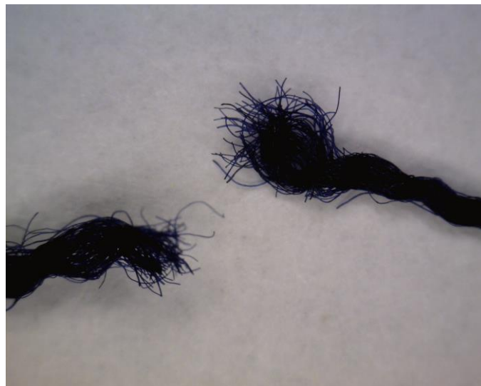
Sl. 26. Prekinuta nit pređe izvađene iz tkanine
