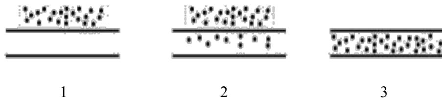
**Sl. 24:** Proces tiskanja: 1- tisk (adsorpcija bojila), 2 – fiksiranje bojila, 3 – naknada dorada [3]
