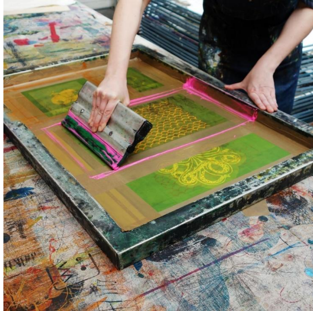
Sl.7.Ručni sitotisk (protiskivanje tiskarske paste rastiralom kroz sito). [7]
