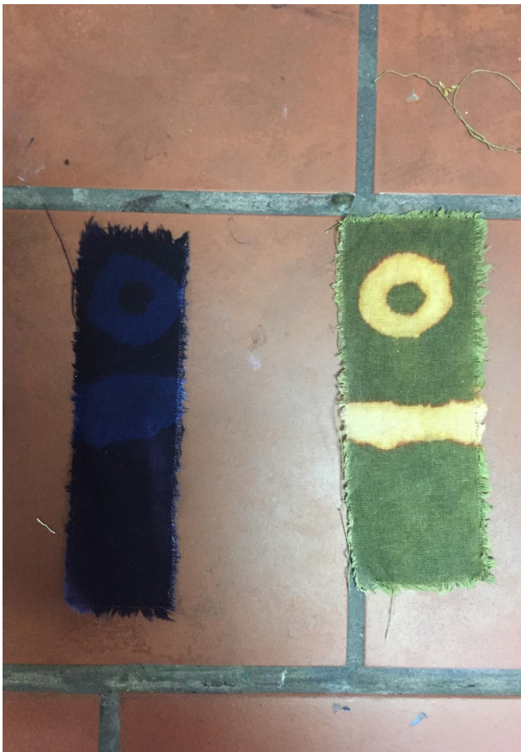
Sl. 19. Probni nanos jetkarske paste na uži izbor kombinacije pigmenat(desno-između zelenog i žutog vidljiv „Burn Out“ radi prerijetke jetkarske paste).[18]
