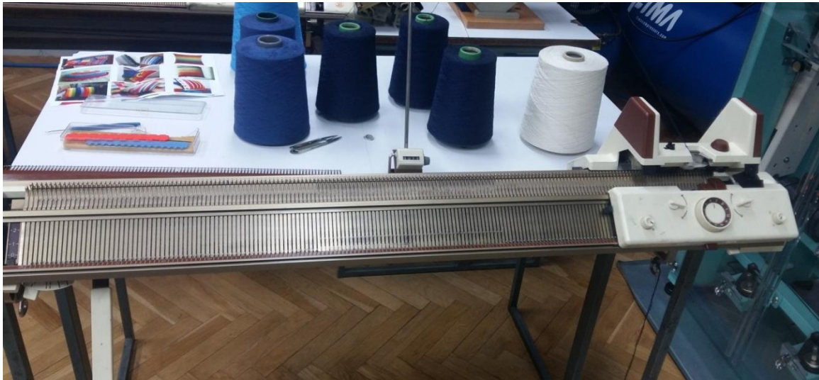
Slika 18. Rad na ručnom ravnopletaćem stroju
