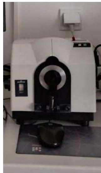
**Slika 13.** Remisijski spektrofotometar Spectraflash SF 300 (Datacolor)
