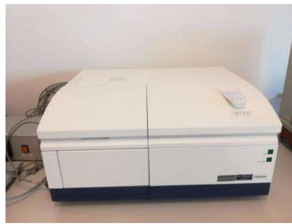
**Slika 12.** Fluorometar HITACHI F-7000 FL
