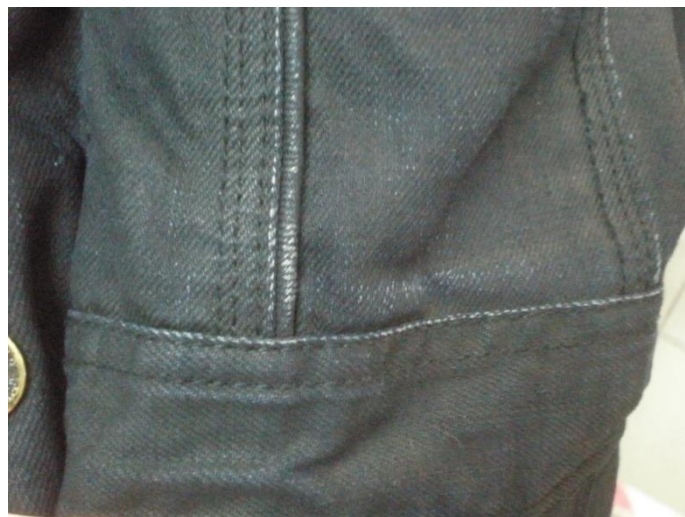
Slika 5. Mjestimične promjene obojenja pod utjecajem trenja
