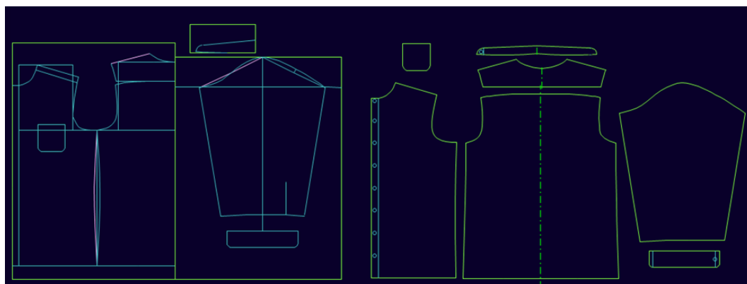
Slika 30 Temeljna konstrukcija muške košulje
