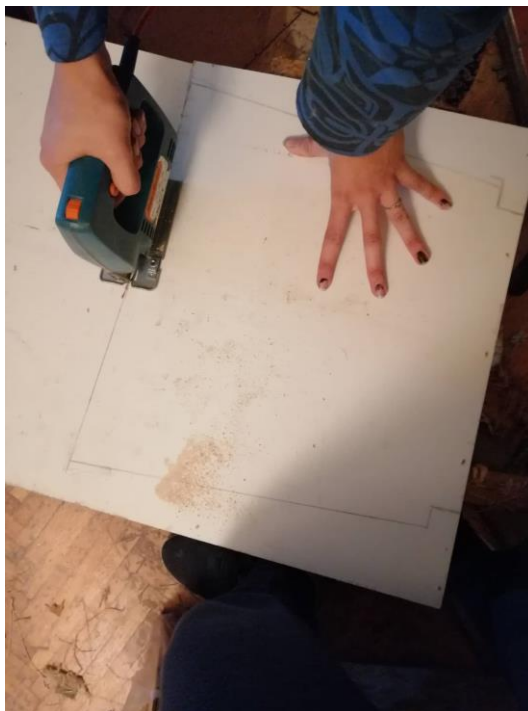
Slika 28: Rezanje šperploče po mjeri za naslon i sjedalo
