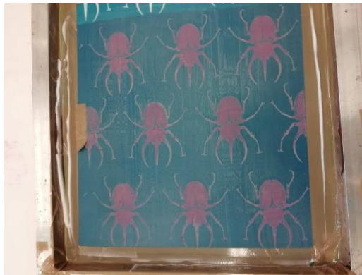
Slika 14: proces ručnog sitotiska
