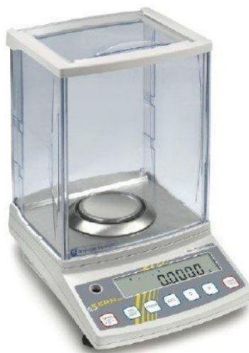
Slika 1. Analitička vaga za vaganje s točnošću od ± 0,0001g
