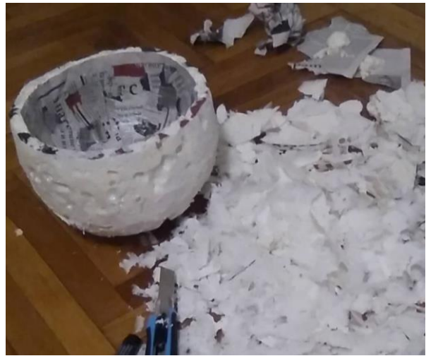
Sl. 18. Proces rezanja viška poliuretanske pjene
