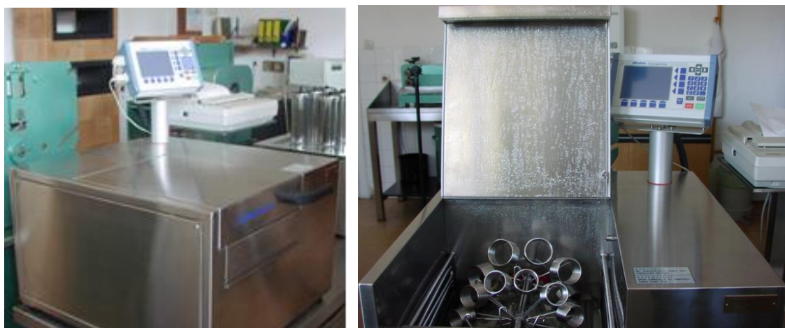
Slika 21. Uređaj za oplemenjivanje i bojadisanje, Turbomat P4502 , Werner Mathis
