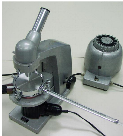
Slika 12: Mikroskop za određivanje tališta Reichert [26]
